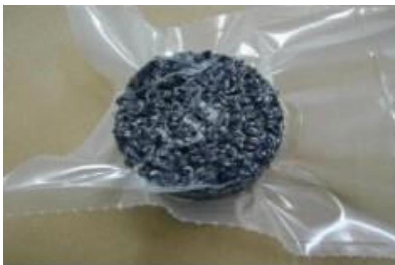
Fotografia 5. Sposób uszczelnienia próbki w metodzie CoreLok
