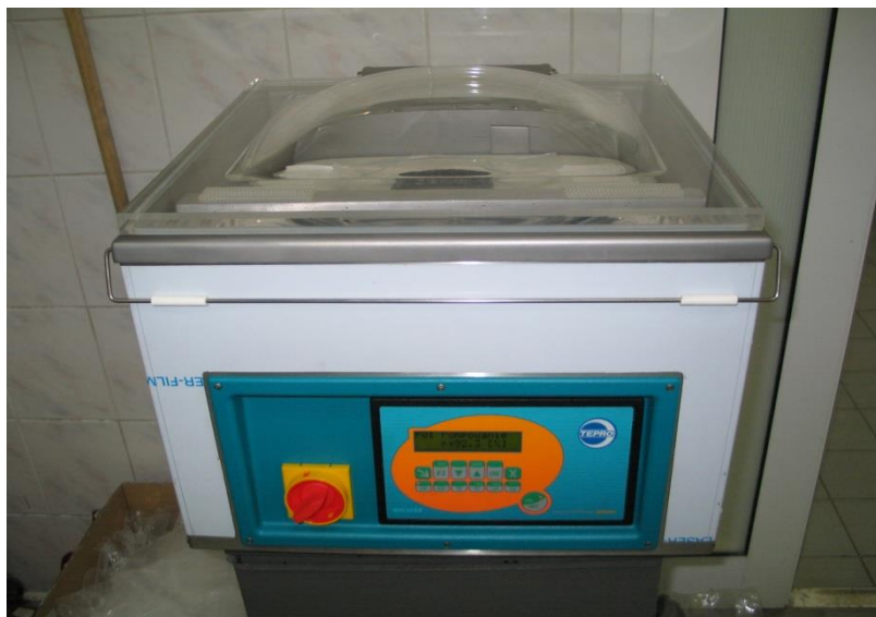
Fotografia 1. Pakowarka próżniowa w IBDiM do badania metodą C
